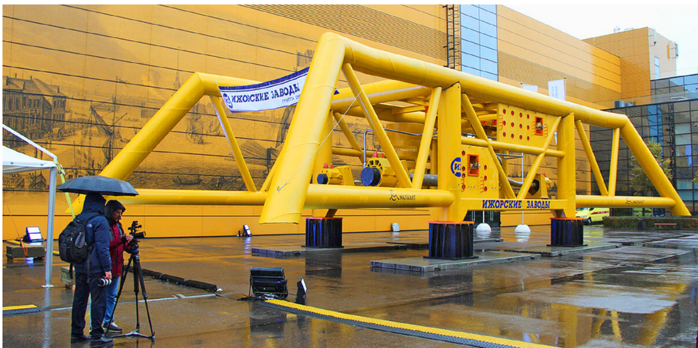
«Ижорские заводы» первыми в России осваивают производство манифольдов — центральных узлов трубопроводной арматуры подводных добычных комплексов, предназначенных для работы на глубоководных шельфовых месторождениях углеводородов. Это оборудование будет использовано при разработке глубоководного Южно-Кирильского нефтегазоконденсатного месторождения
